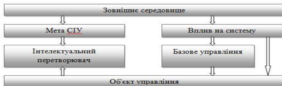
Рис. 1. Структурна схема базової системи інтелектуального управління
