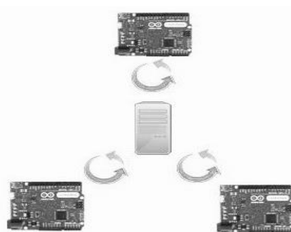
Рис. 2. Принцип роботи системи без центрального контролера
