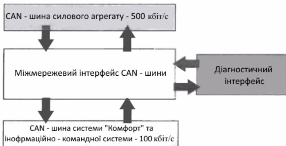
Рис. 3. Блок-схема між мережевого інтерфейсу
