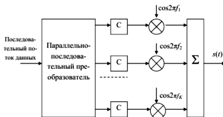
Рис. 7. Структурна схема прямого формування OFDM-сигналів
