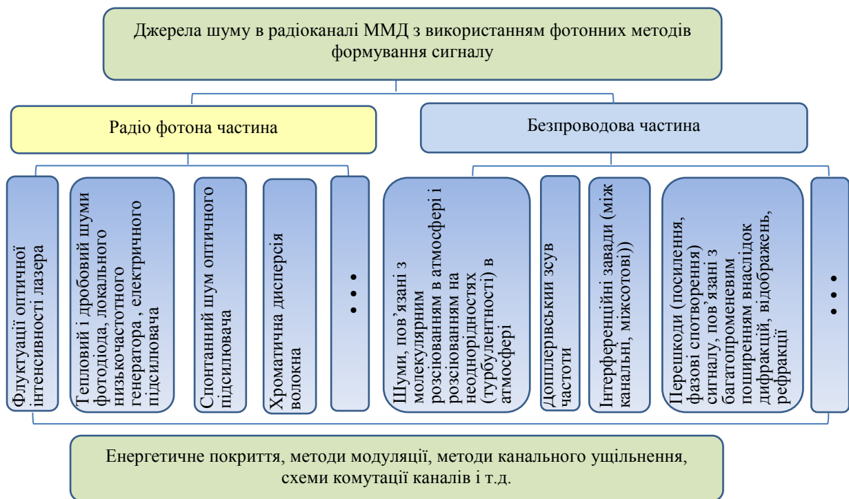
Рис.3 Можливі джерела шуму і завад в радіоканалі ММД з використанням RoF технології
