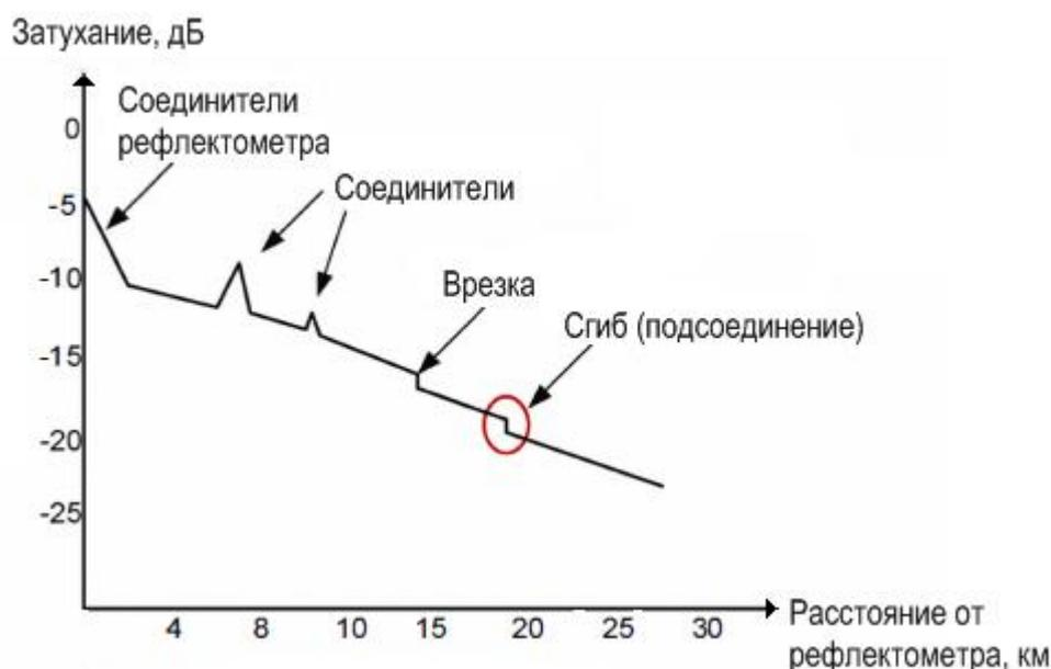
Рис. 6. Обнаружение подключения на оптической трассе с помощью оптического рефлектометра
