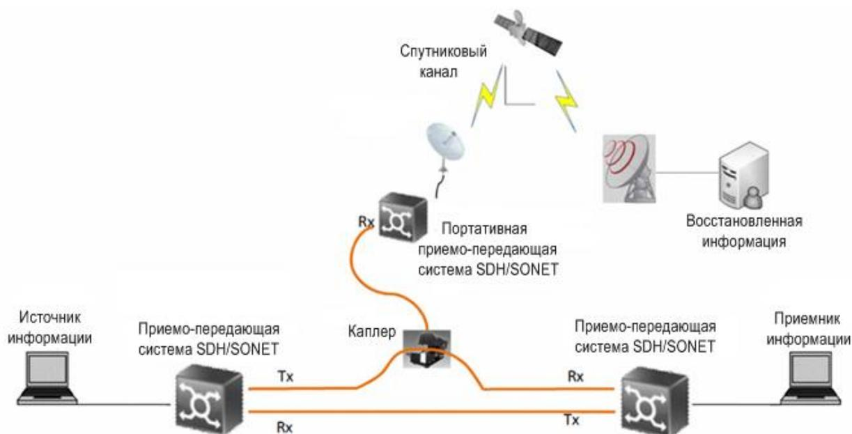
Рис. 5. Вариант подсоединения к оптоволокну с удаленной обработкой
