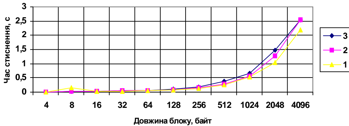
Рис. 1. Залежність часу стиснення від розміру, стисливого блока
