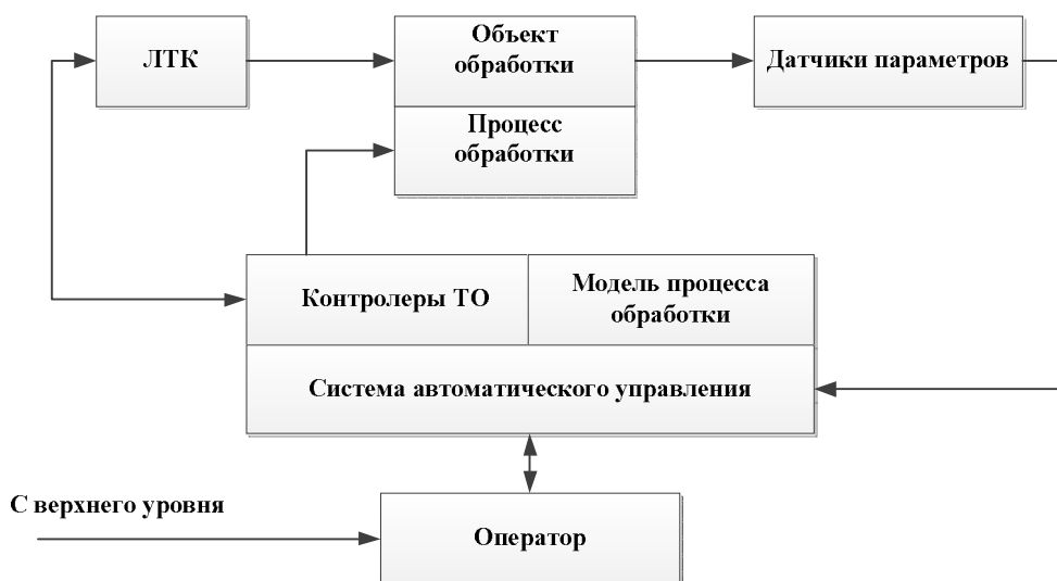
Рис. 1. Структурная схема АЛТК
