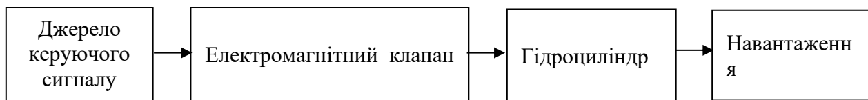
Рис. 1. Блок-схема розімкненої САК із гідроприводом
