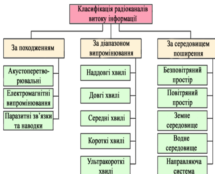
Рис.1 Класифікація радіоканалів витоку інформації
