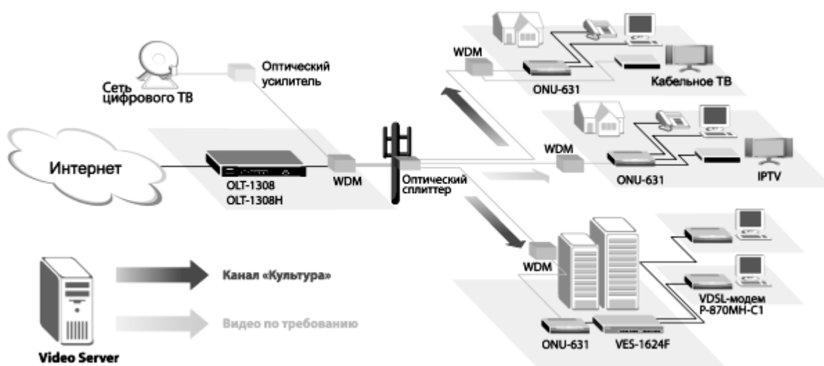
Рис.3 Мультисервисная сеть на базе технологии GPON
