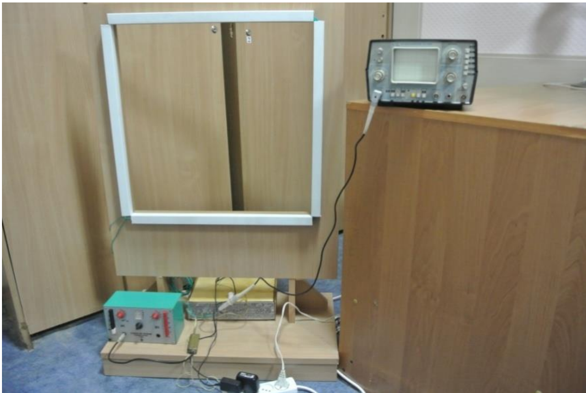
Рис. 5. Зовнішній вигляд обладнання для дослідження просторових характеристик ближнього поля рамкової антени
