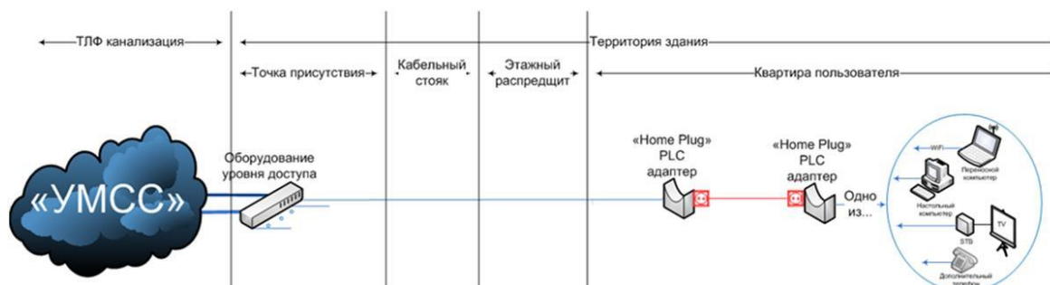
Рис. 2. Сценарий 1 применения SOHO BPL: «Замена квартирной разводки»
