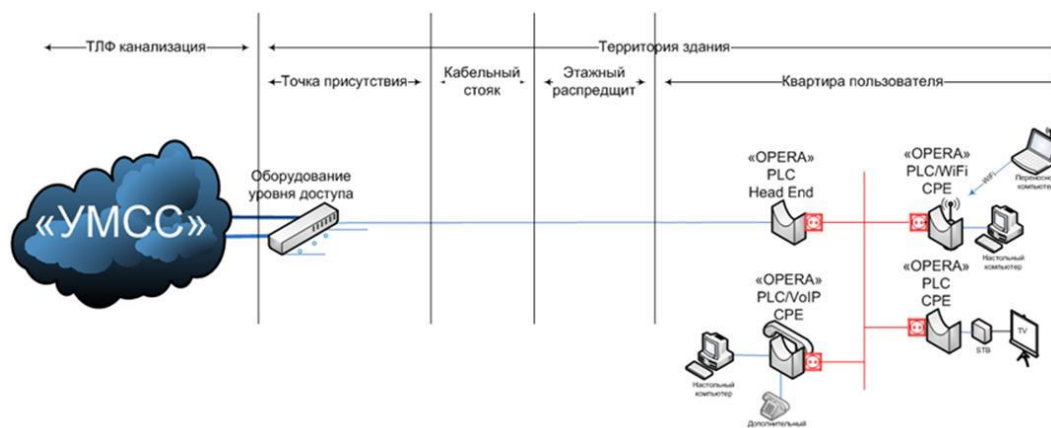
Рис. 3. Сценарий 2 применения Access BPL: «Замена квартирной разводки»
