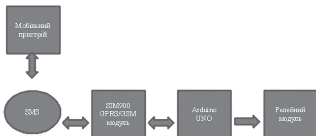
Рис. 1. Блок-схема прототипа управління електроприладами за допомогою модуля GSM і Arduino
